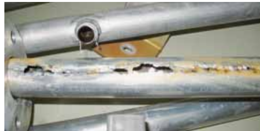
altes defektes Eintragsystem
